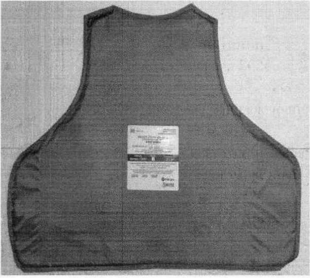
Рис. 3.1 - Внешний вид спинной секции в сборе и вставки баллистической (уч. № 12/26).
